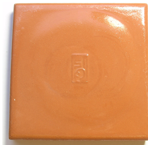
Fig. 7. TiO 2 /glaze-coated PRC tile.
